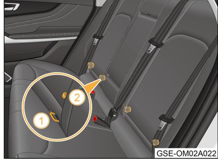
Hay cuatro anclajes de fijación ISOFIX ① para la parte inferior del asiento para niños en el espacio entre el respaldo del asiento trasero y el cojín del asiento, que se utilizan para ayudar en la instalación del asiento para niños. La identificación ② se utiliza para indicar la posición de la interfaz fija ISOFIX.
