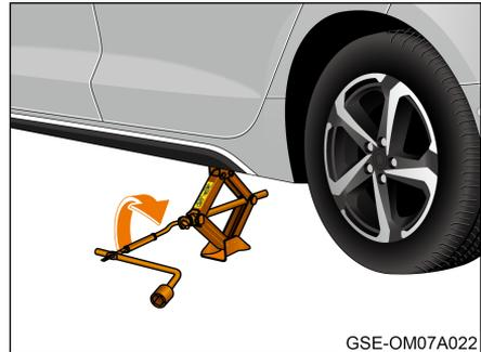
2. Inserte el balanceo en el gato, gire el balanceo en el sentido de las agujas del reloj con la llave para tornillos de rueda y levante lentamente el gato para que el neumático quede ligeramente separado del suelo.
