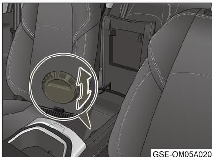
El interruptor del refrigerador está situado dentro del guardabultos de la consola central.
