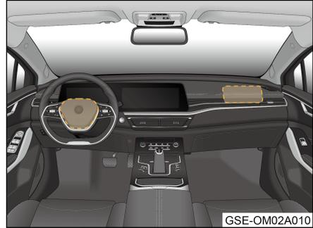
El airbag frontal del conductor está instalado en el volante y el del pasajero delantero, en el salpicadero sobre la guantera, identificado por las letras "AIRBAG".
