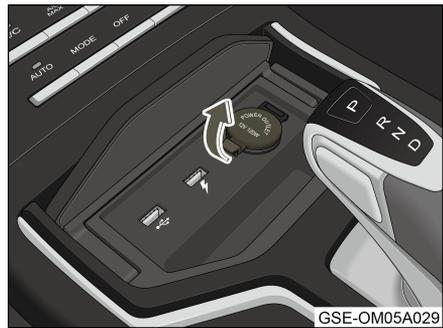
2. Cuando la alimentación de todo el vehículo está en estado "ON", abra la tapa de la alimentación a bordo y conecte el equipo eléctrico para empezar la carga.
