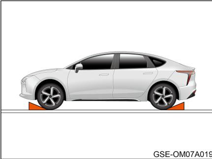
6. Coloque bloques delante de las ruedas delanteras y detrás de las ruedas traseras para evitar que el vehículo se deslice.
