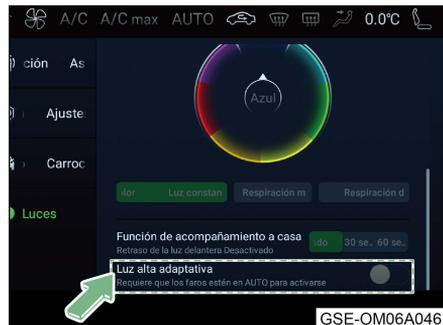
Puede encender o apagar el sistema HMA a través de la pantalla táctil multimedia "Configuración del vehículo → Luces".
