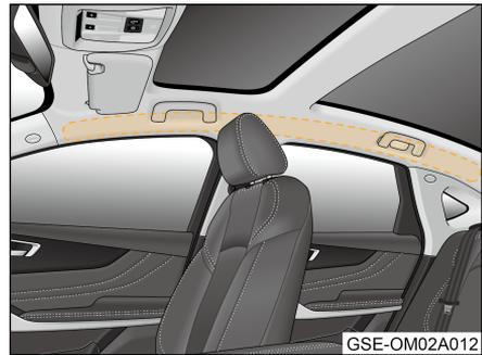
Los airbags de cortina están instalados en el interior del costado del techo de vehículo, identificados por las letras "AIRBAG".
