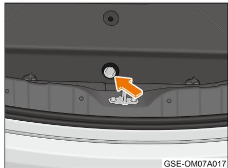
4. Afloje los tornillos de fijación del soporte del neumático de repuesto con la llave para tornillos de rueda.
