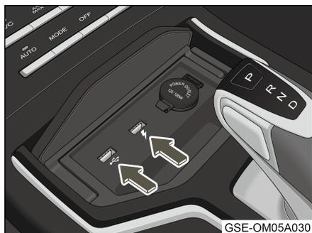
2. El puerto USB izquierdo se puede usar para cargar y leer datos, y el derecho solo se usa para cargar.
