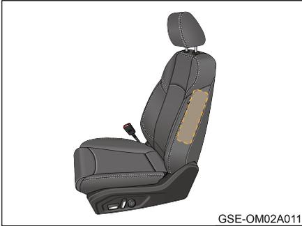
Los airbags laterales delanteros están instalados en los costados de respaldos del asiento del conductor y del pasajero delantero, identificados por las letras "AIRBAG".
