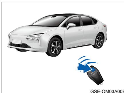
Cuando la alimentación de todo el vehículo está en estado "OFF", dentro del rango de operación efectivo de la llave remota, presione la tecla de desbloqueo de la llave remota, todas las puertas se desbloquearán al mismo tiempo y las luces indicadoras de dirección parpadearán 2 veces.
