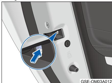
1. Inserte la llave mecánica en la posición como se muestra en la imagen.
