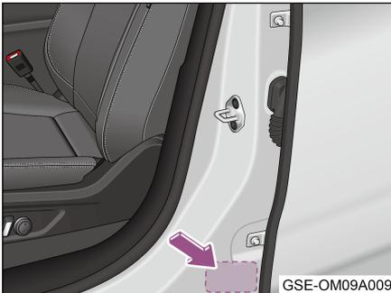
La placa adicional de identificación del vehículo está pegada debajo de la elevación del pilar B en el lado del conductor.
