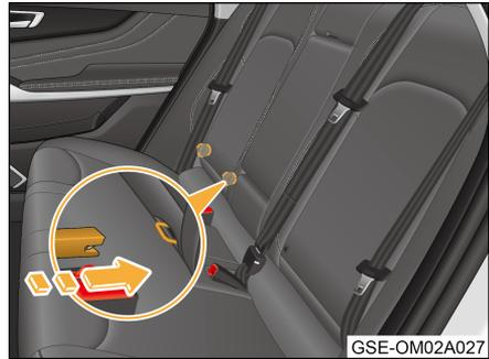
2. Fije correctamente el mecanismo de bloqueo inferior del asiento para niños y los 2 anclajes de fijación de ISOFIX/i-Size del asiento trasero.
