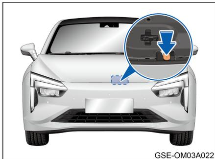
2. Extienda su mano en el área que se muestra en la imagen, presione la manija de desbloqueo de la cerradura secundaria del capó del motor. Mientras tanto, levante el capó hacia arriba hasta que éste esté completamente extendida.
