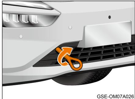
2. Inserte la anilla de remolcado en el punto de remolcado, gírelo en el sentido de las agujas del reloj y apriételo ligeramente. (Tomando el punto de remolcado delantero como ejemplo)
