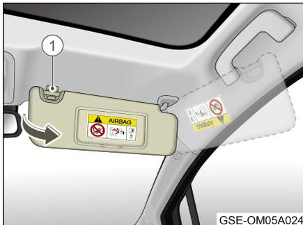
Después de bajar el quitasol, desconecte el gancho de fijación ① y gire el quitasol en la dirección de la ventanilla lateral para bloquear la luz deslumbrante del costado.
