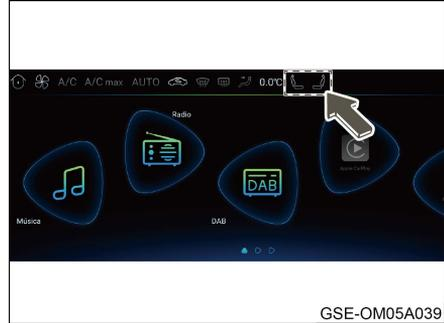
Puede activar, ajustar o desactivar la función de calentamiento de los asientos del conductor/del pasajero delantero a través de la pantalla táctil multimedia.
