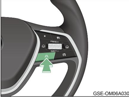
Al presionar la tecla de encendido/apagado del mantenimiento del carril en la parte derecha del volante, podrá activar o desactivar el sistema LKA.
