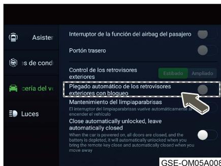
Después de encender el interruptor de pliegue automático de los retrovisores exteriores al bloquear el vehículo a través de la pantalla táctil multimedia "Configuración del vehículo → Carrocería":
