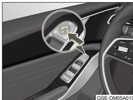
2. Presione las 4 teclas de dirección en la tecla redonda para ajustar el espejo al ángulo apropiado.
