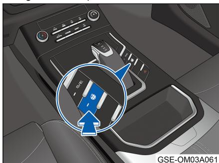
Cuando la alimentación de todo el vehículo esté en estado "ON" o "READY", presione la tecla de calentamiento del volante, la luz indicadora de la tecla se encenderá y la función de calentamiento del volante se activará; presione esta tecla nuevamente, la luz indicadora de la tecla se apagará y a función de calentamiento del volante se desactivará.
