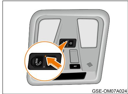
En caso de accidente del vehículo o expulsión de los airbags, las luces LED mostradas en la imagen parpadearán y se activará la E-call automáticamente. En este momento, solo espere a que se conecte el teléfono de rescate. Si las luces LED no parpadean, por favor active manualmente la E-call.
