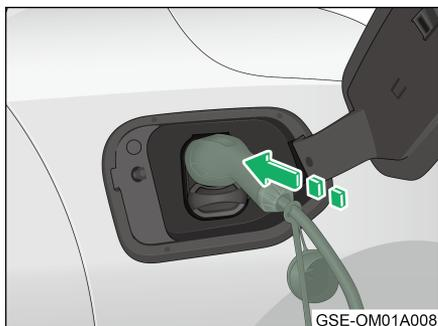
4. Inserte la asa de carga en la toma de carga de CA del vehículo y asegúrese de que el bloqueo mecánico de la asa de carga esté insertado en el bloqueo mecánico de la base de carga del vehículo.
