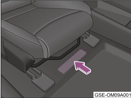
1. El número de identificación del vehículo (VIN) está grabado en la viga de montaje delantera del asiento del pasajero delantero.
